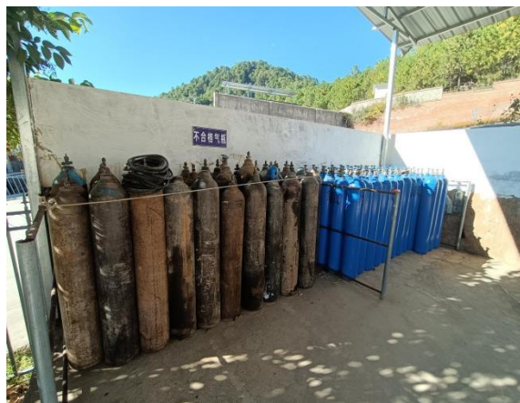
不合格气瓶存放区
